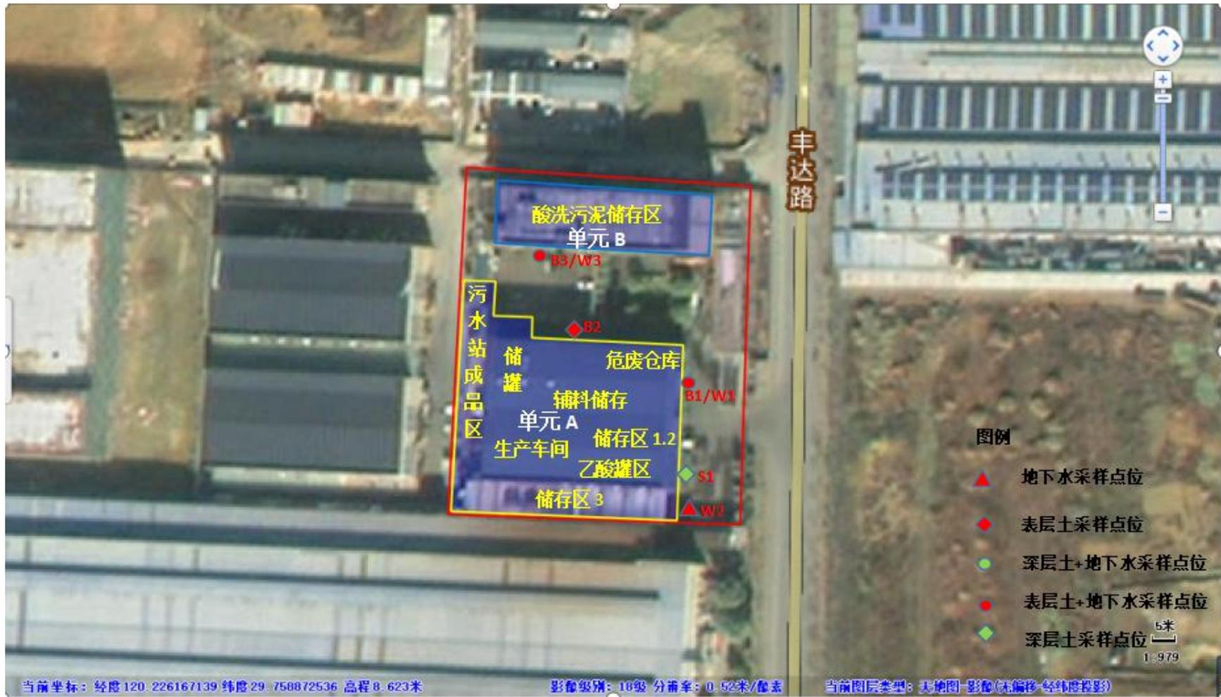
图 6.1-1 监测点位示意图(B 表示表层采样点, S 表示深层采样点, W 表示地下水监测井)
