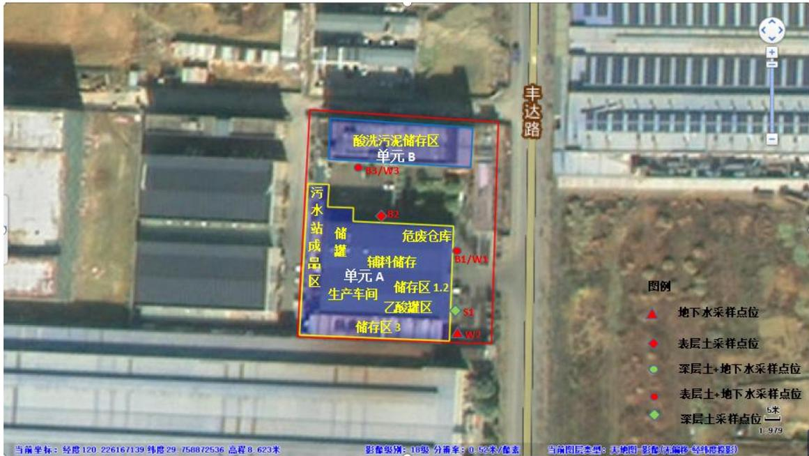
图 2.3-1 2022 年监测点位分布图（B 表示表层采样点，S 表示深层采样点，W 表示地下水监测井）
