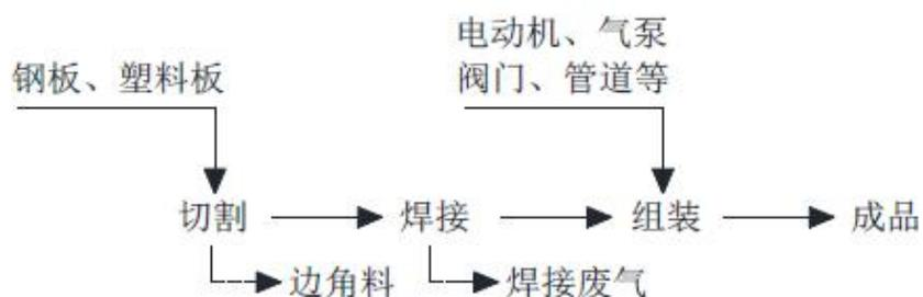
图 4.1-1 生产工艺流程图
