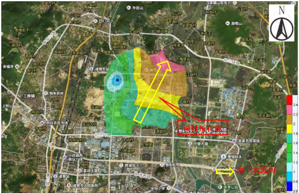
图3-2 地下水埋深流场图
